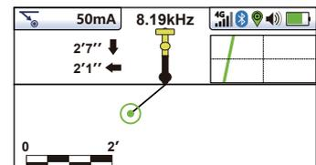
**Mode vectoriel déporté** – Très utile quand la mesure juste au-dessus du réseau n'est pas possible à cause d'un obstacle. Les deux jeux de trois antennes permettent de visualiser la distance au réseau et la profondeur.
